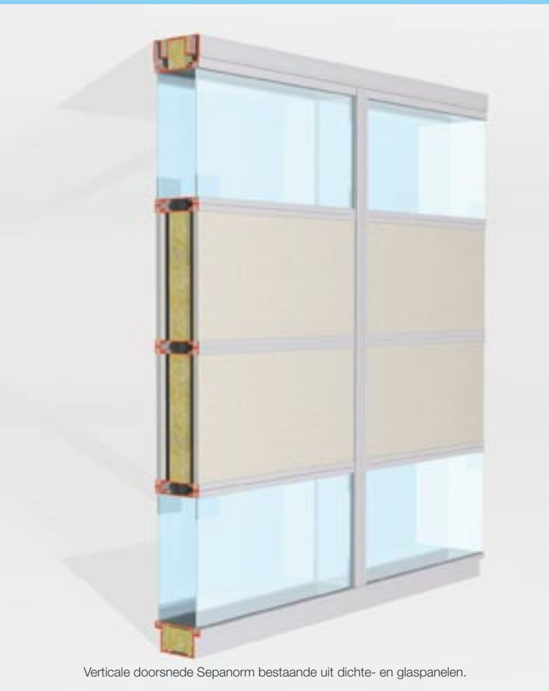
Verticale doorsnede Sepanorm bestaande uit dichte panelen.
