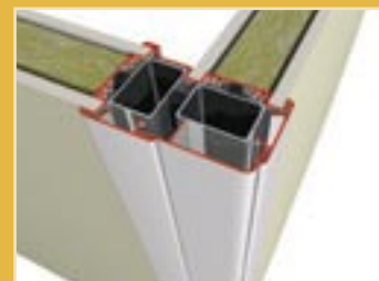
Horizontale doorsnede van een 90° hoekoplossing.
