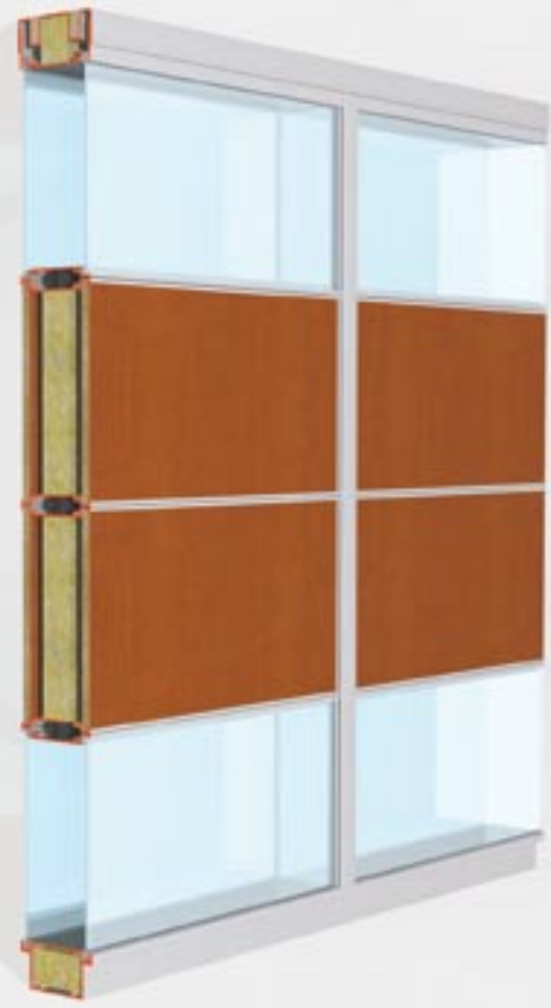
Alternatief Verticale doorsnede Sepaligno bestaande uit dichte- en glaspanelen.
