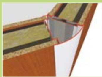
Horizontale doorsnede van een ronde hoekoplossing (135°).
