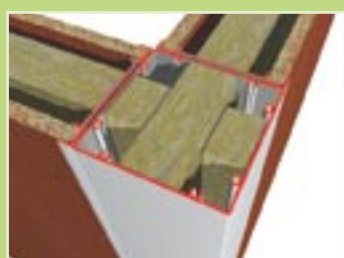
Horizontale doorsnede van een rechte hoekoplossing (90°).
