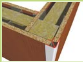
Horizontale doorsnede deurkozijn (afgerond)
