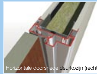
Horizontale doorsnede deurkozijn (afgerond)
