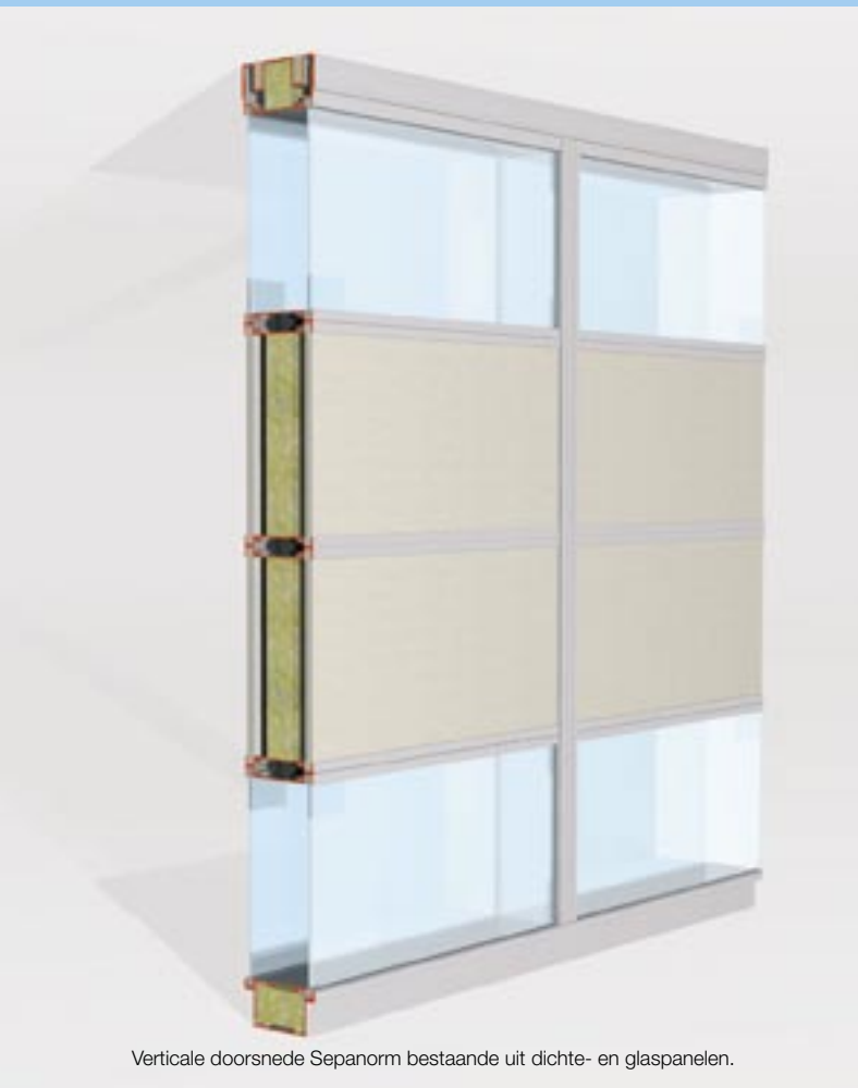
Verticale doorsnede Sepanorm bestaande uit dichte panelen.
