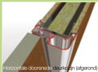
Horizontale doorsnede deurkozijn (afgerond)
