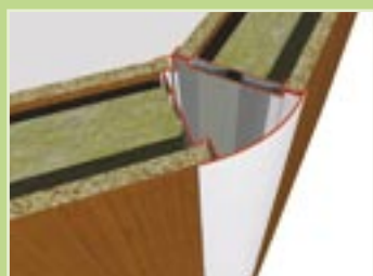
Horizontale doorsnede van een ronde hoekoplossing (135°).
