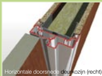
Horizontale doorsnede deurkozijn (recht)
